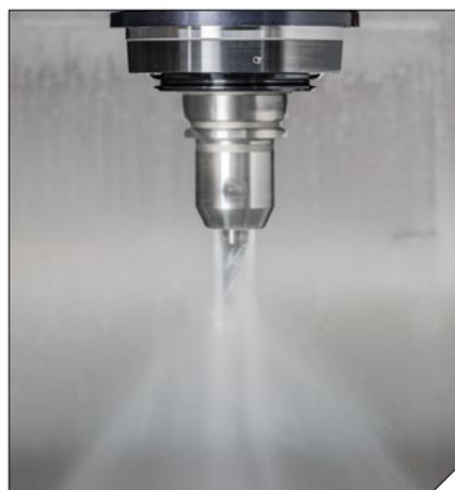
Se for necessário o resfriamento através do eixo da ferramenta, os tampões de rosca devem ser instalados. Além disso, o diâmetro de saída dos furos CoolBore pode ser reduzido para 0,5 mm utilizando bicos redutores. Isso aumentará o efeito do jato de refrigerante.
