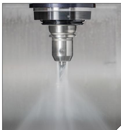
Se è richiesto il raffreddamento attraverso il gambo dell'utensile, è necessario montare i tappi a vite. Inoltre, il diametro di uscita dei fori CoolBore può essere ridotto a 0,5 mm utilizzando ugelli riduttori, permettendo così di aumentare l'effetto del getto di refrigerante.
