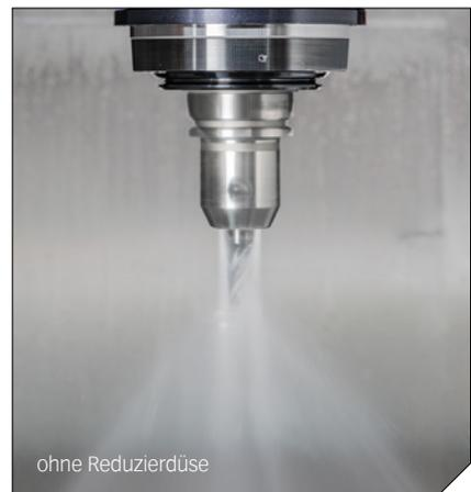
Wenn Kühlung durch den Werkzeugschaft gefordert ist, müssen die Verschlusschrauben montiert werden. Über Reduzierdüsen kann zudem der Austrittsdurchmesser der CoolBore Bohrungen auf 0.5mm reduziert werden. Dies verstärkt den Kühlmittelstrahl in seiner Wirkung.
