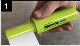
1 Insérez le papier de nettoyage par l'avant dans la fente du cône de nettoyage, poussez-le à fond vers l'arrière et alignez le début du papier au ras de la fente opposée.
