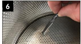
6 Dégraisser la tige de l'outil. Le meilleur moyen est d'immerger l'outil dans un liquide propre et dissolvant la graisse (par exemple de l'alcool, un nettoyeur à froid, etc.).
