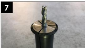
7 Séchez le mandrin de la pince de serrage. N'utilisez de l'air comprimé que s'il est propre et sans huile. Insérez l'outil dans la pince de serrage.
