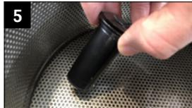
5 Dégraisser la pince de serrage. Le meilleur moyen est d'immerger l'outil dans un liquide propre et dissolvant la graisse (par exemple de l'alcool, un nettoyeur à froid, etc.).
