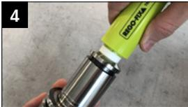
4 Insérez complètement le nettoyeur de cône dans le porte-outil. Nettoyez l'interface powRgrip® sur le porte-outil avec un mouvement de rotation.
