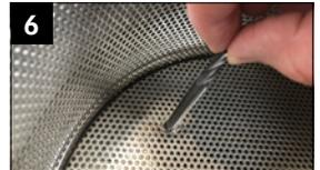
6 Limpie el mango de la herramienta sumergiéndolo en un disolvente limpio y soluble en aceite, (por ejemplo, alcohol, limpiador en frío).
