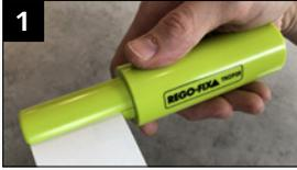
1 Inserte el papel de limpieza en la ranura del limpiador cónico desde el frente. Deje suficiente papel para cubrir todo el ancho de la ranura. Empujar hacia abajo hacia el reborde hasta que esté completamente asentado.
