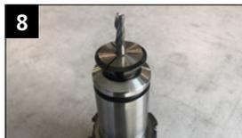
8 Inserte la herramienta en el pinza. Inserte el conjunto del portaherramientas en la unidad powRgrip® y presione la pinza.
