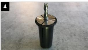
Asciugare il solvente con aria compressa senza olio. Inserire l'utensile nella pinza di serraggio.
