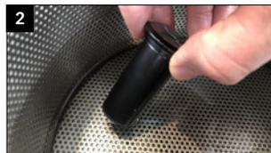
Sgrassaggio / pulizia della pinza di serraggio powRgrip®. Immergere in un solvente pulito e solubile in olio (ad es. alcool, detergente a freddo).
