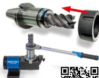
L'utensile da taglio è ora saldamente bloccato nel portautensili e pronto per essere utilizzato nella macchina utensile.
