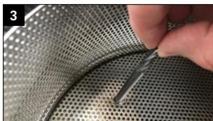
Pulire il gambo dell'utensile immergendolo in un solvente pulito e solubile in olio (ad es. alcool, a freddo).
