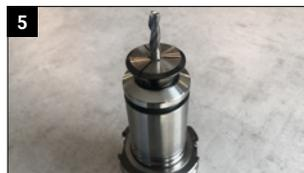
Inserire l'utensile nella pinza di serraggio. Inserire il gruppo portautensile nell'unità powRgrip® e premere nella pinza.
