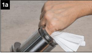
Nettoyez l'intérieur du porte-pinces powRgrip® manuellement avec un chiffon propre. Insérez le chiffon dans le porte-outil avec un ou deux doigts et essuyez tout le cône intérieur sur toute sa longueur et son diamètre.
