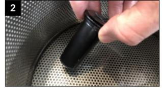
Dégraisser la pince de serrage. Le meilleur moyen est d'immerger l'outil dans un liquide propre et dissolvant la graisse (par exemple de l'alcool, un nettoyant à froid, etc.).
