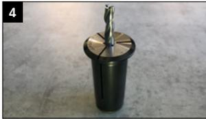
Séchez le mandrin de la pince de serrage. N'utilisez de l'air comprimé que s'il est propre et sans huile. Insérez l'outil dans la pince de serrage.
