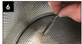
Werkzeugschaft entfetten. Am besten durch Eintauchen in einer sauberen, fettlösenden und ölfreien Flüssigkeit (z.B. Alkohol, Kaltreiniger, usw.).
