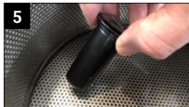
powRgrip®-Spannzange entfetten. Am besten durch Eintauchen in einer sauberen, fettlösenden und ölfreien Flüssigkeit (z.B. Alkohol, Kaltreiniger, usw.).
