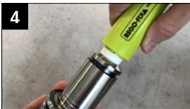
Kegelreiniger ganz in den Halter einführen. Mit Drehbewegung powRgrip®- Schnittstelle am Halter sauber reinigen.
