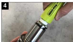
4 Inserire il pulitore conico completamente nella sede della pinza di serraggio del portapinze. Girare per pulire.
