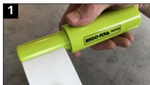
1 Inserire la carta per la pulizia nella fessura del pulitore conico dalla parte anteriore. Spingere verso il basso la carta fino a quando non si è completamente inserita.
