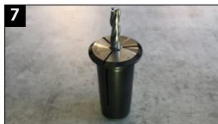
7 Asciugare il solvente con aria compressa senza olio. Inserire l'utensile nella pinza di serraggio.
