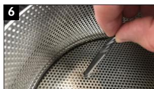
6 Pulire il gambo dell'utensile immergendolo in un solvente pulito e solubile in olio (ad es. alcool, a freddo).
