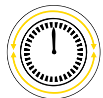
Drehbares Ziffernblatt, zur Nullstellung der Skala
