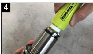
4 Insira o limpador de cone completamente no cone. Limpe a interface powRgrip® no suporte com um movimento rotativo.
