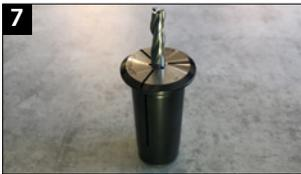
Spannzange trocknen. Pressluft nur verwenden, wenn diese sauber und ölfrei ist. Werkzeug in die Spannzange einführen.
