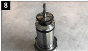
Spannzange in den Werkzeughalter stellen und mittels Spanneinheit einpressen.
