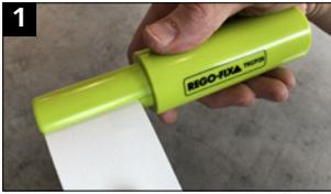
Das Reinigungspapier von vorne in den Schlitz des Kegelreinigers einführen, ganz nach hinten an den Anschlag schieben und den Papieranfang bündig mit dem gegenüberliegenden Schlitz ausrichten.
