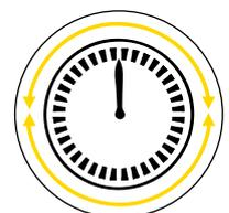
Drehbares Ziffernblatt, zur Nullstellung der Skala
