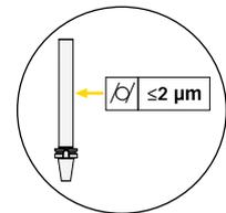
Zylindrizität des Prüfdorns  $\le 2 \mu\text{m}$
