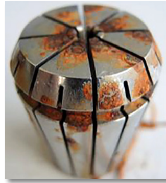
Rostfreie ER-Spannzange eines Mitbewerbers (DE) Material: DIN 1.4034
