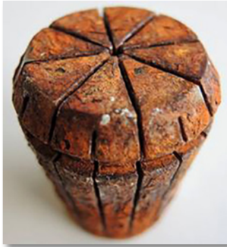
Standard ER-Spannzange Material: herkömmlicher Federstahl
