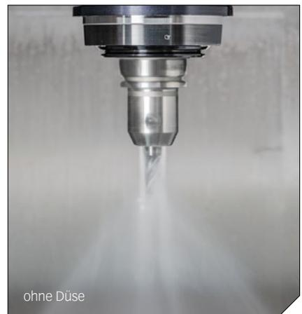
Wenn Kühlung durch den Werkzeugschaft gefordert ist, müssen die Verschlusschrauben montiert werden. Zudem kann über Reduzierdüsen der Austrittsdurchmesser der CoolBore Bohrungen auf 0.5mm reduziert werden. Dies kann den Kühlmittelstrahl in seiner Wirkung verstärken.
