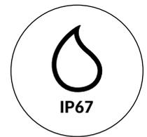
Resistente alla polvere e Impermeabile secondo la norma IP67
