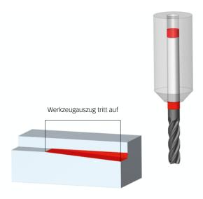
Längenveränderungen können zu einer Beschädigung des Werkstücks führen.
