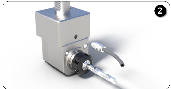
クーラントパイプ、ERナット、工具を取り外す
