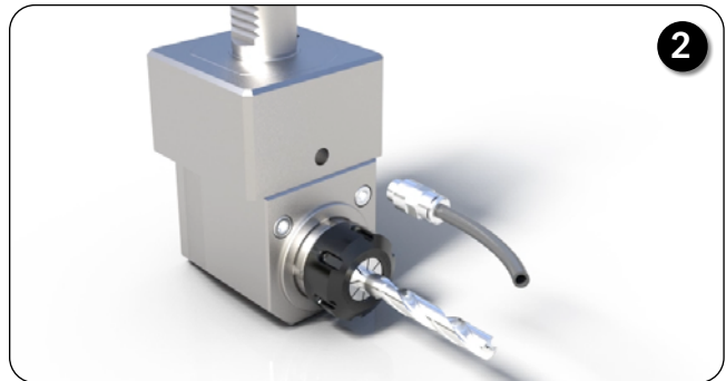
Démontage du tube de lubrification, de l'écrou de serrage ER et de l'outil coupant
