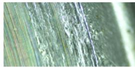
Metallisch-blanke Spannmutter nach 15 Spannzyklen
