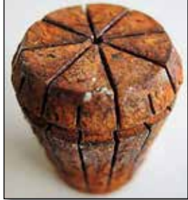
Standard ER-Spannzange / Material: herkömmlicher Federstahl
