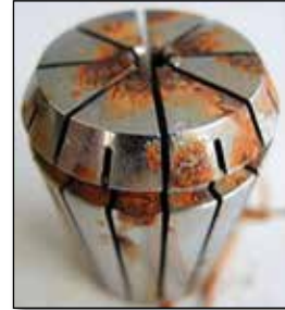
Rostfreie ER-Spannzange eines Mitbewerbers (DE) / Material: DIN 1.4034
