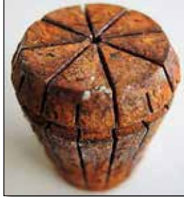
Standard ER-Spannzange / Material: herkömmlicher Federstahl
